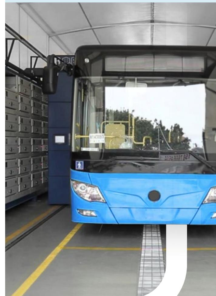
Figure 3. Centre de test robotisé pour l'échange de batteries
