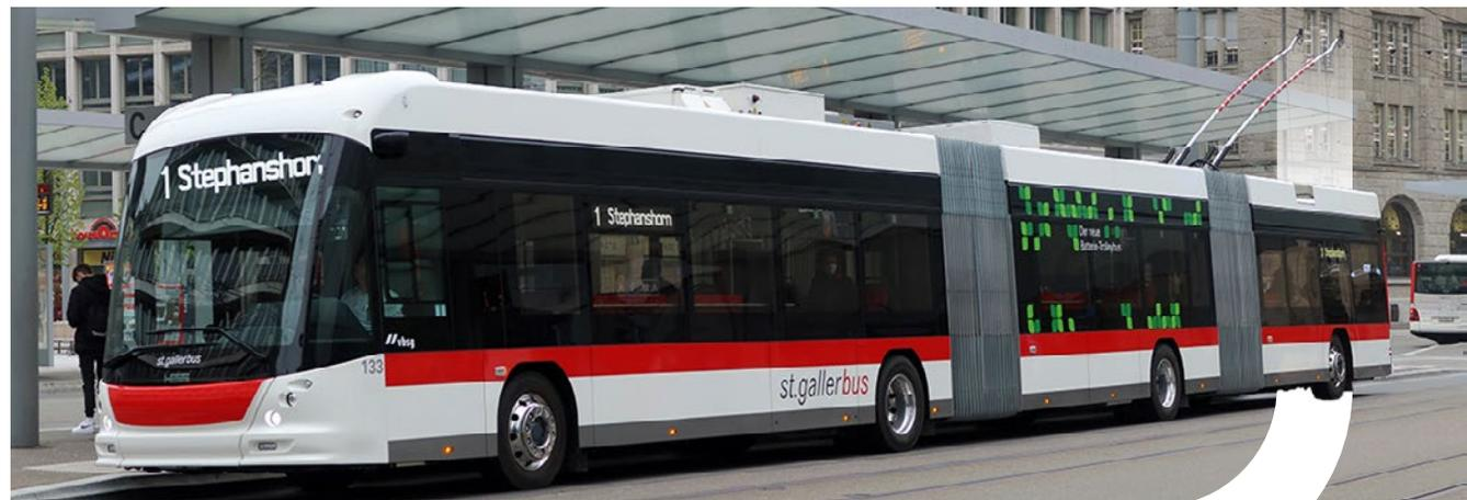
Figure 4. Autobus avec caténaire Source photo: Flickr "VBSG - Hess lighTram 25 DC" par Kecko
